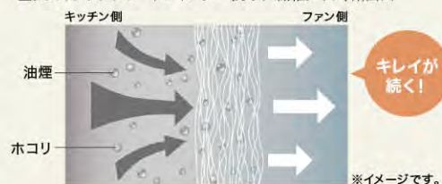
■ダスキンのレンジフードフィルター(ガラス繊維タイプ)断面図
